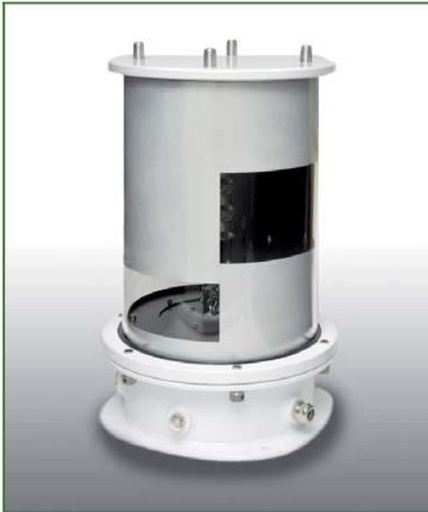
A MBL 400-S é uma luz de setor LED de médio alcance, com um excelente desempenho de seu sistema óptico, fornecendo feixes de luz segmentados com uma precisão de até  $0,5^\circ$ . Sua fonte luminosa consiste em diodos de LED de alta intensidade, proporcionando uma faixa luminosa de até 12 milhas náuticas. Destinada a ser colocada em locais de auxílio para navegação, como postes e torres, bem como locais difíceis de alcançar ou em condições ambientais extremas.
